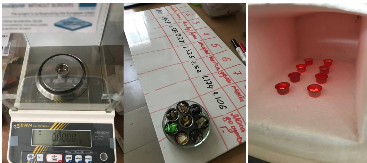
Рис. 1. Підготовка зразків ТПВ і пелет для визначення зольності
