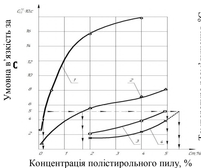
Рис. 4. Діаграма для визначення еквів'язкої ( C_{50}^{10}=50 с) концентрації C_m ПСП у в'язучому на дьогтях з вихідною в'язкістю: 1 – C_{30}^{10}=29 с; 2 – C_{30}^{10}=250 с; 3 – C_{30}^{10}=150 с; 4 – C_{30}^{10}=50 с
