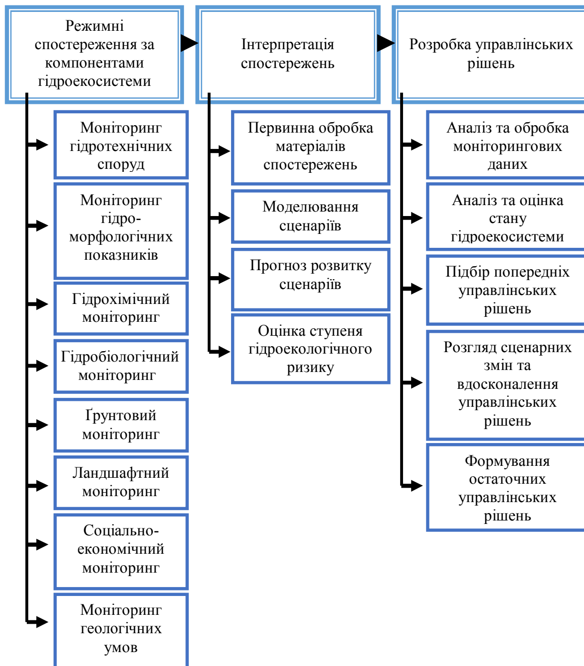
Рис. 1. Функціональна схема організації моніторингу гідроекосистеми
