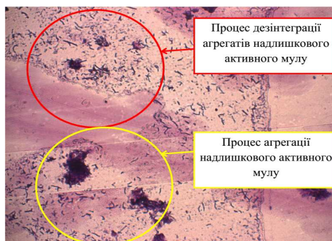
Рис. 3. Формування агрегатів бактерій у процесі АМД. Світлова мікроскопія. Забарвлення за методом Грама. 36. х40
