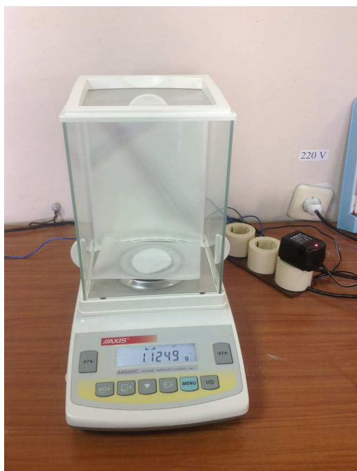
Рис. 4. Зважування чистої вати на аналітичних терезах
