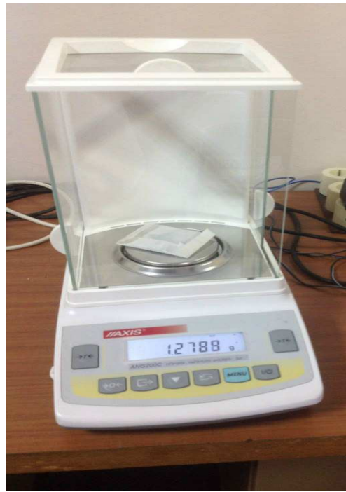
Рис. 6. Зважування вати з пилом на аналітичних терезах
