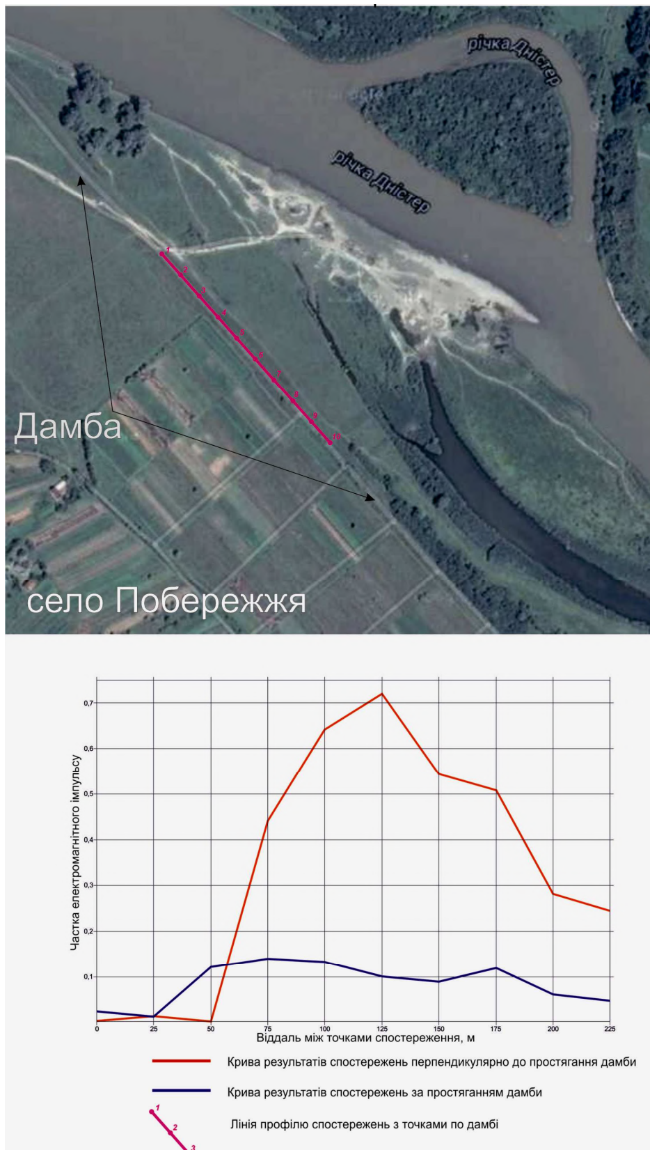
Рис. 10. Дослідження дамби за допомогою ПЕМПЗ
