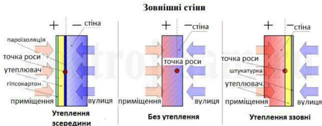
Рис. 4. Розміщення точки роси на зовнішніх стінах для різних варіантів: утеплення зсередини, без утеплення та утеплення ззовні
