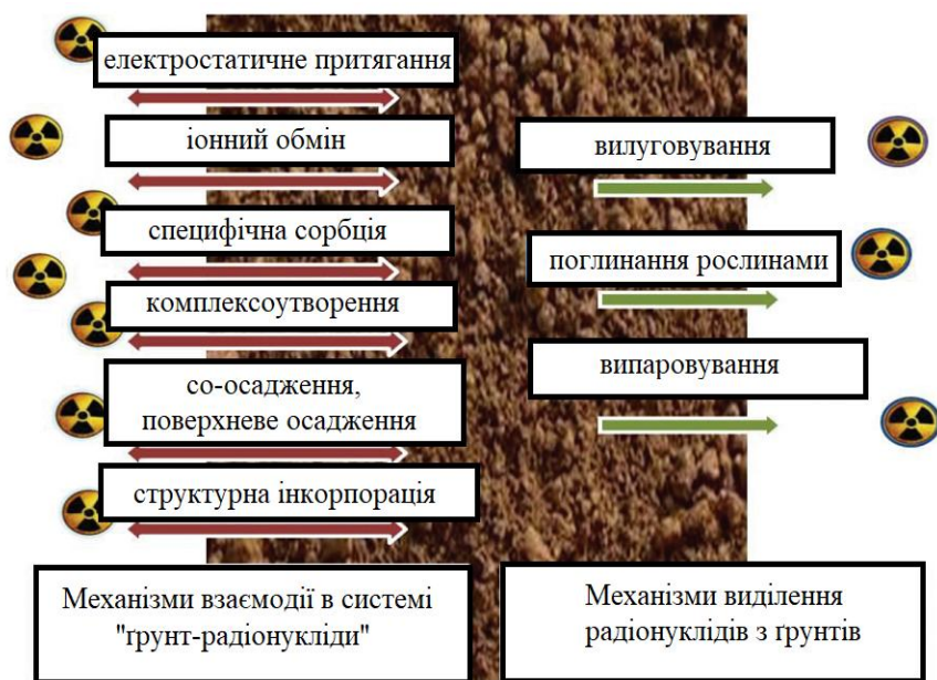
Рис. 3. Механізми зв'язування і елімінації радіонуклідів з ґрунтового матриксу згідно з [8]
