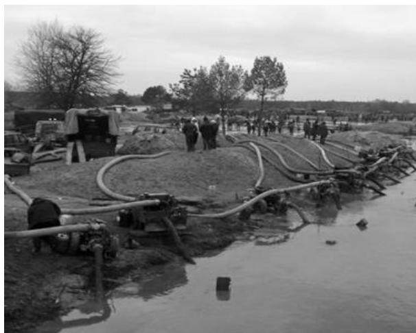
Рис. 2. Гідромеханічний спосіб видобутку бурштину
