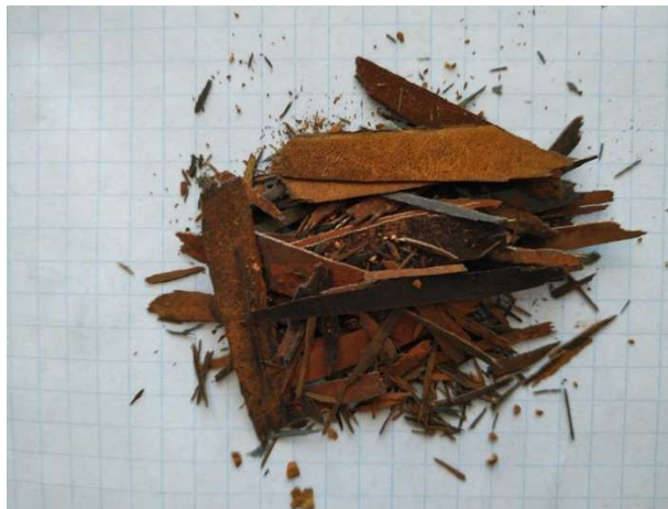
Рис. 1 Фрагменти накипу, утвореного на стінках водонагрівача в садибі с. Витвиці
