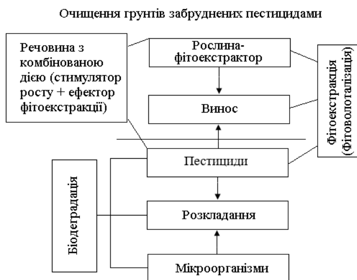
Рис. 3. Загальна схема очищення ґрунтів від пестицидів
