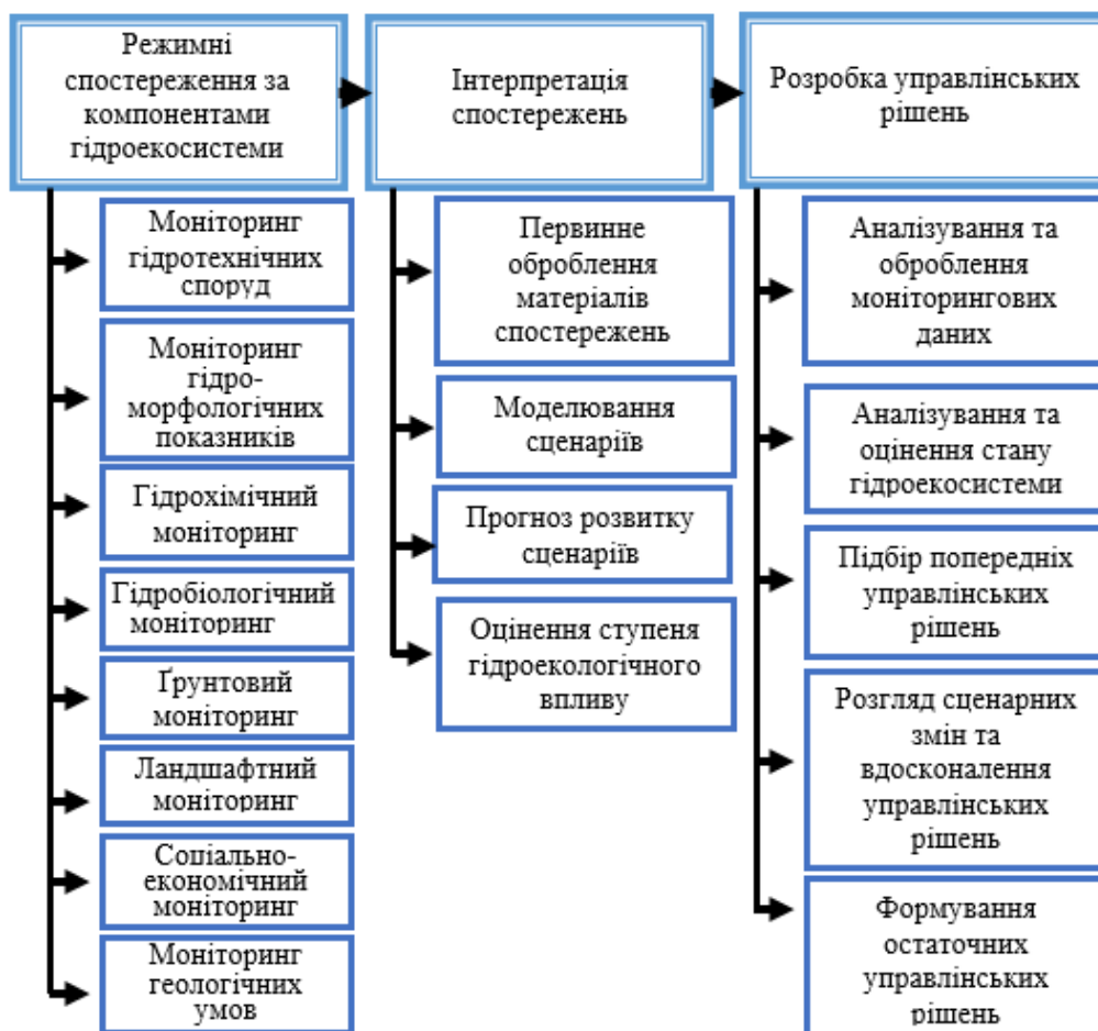
Рис. 8. Вдосконалена функціональна схема організації моніторингу гідроєкосистеми
