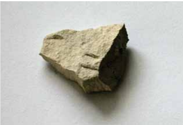
Фото 5 Зразок мергелю на початок експерименту
